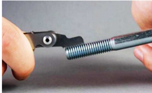
Rys. 1. Pomiar gwintu wzornikiem
