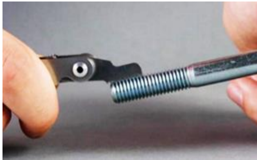
Rys. 1. Pomiar gwintu za pomocą wzornika zarysu
