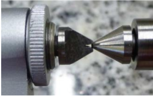
Rys. 4. Wzorcowanie mikrometru: 1- regulacja przesunięcia konika, 2- końcówka przyzmatyczna, 3- końcówka stożkowa, 4- wzorec nastawczy do gwintów
